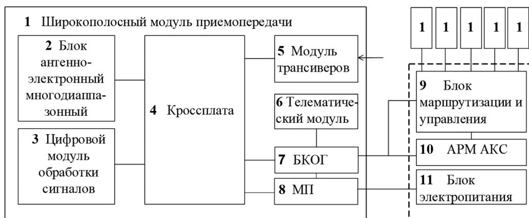
Рис. Функциональная схема соединений корабельной системы широкополосной связи:
