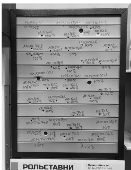
Рис. 8. Образец испытанный на пулестойкость
