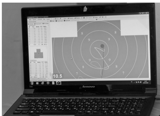
Рис. 5. Результаты изготковки, нажатия на спусковой крючок и попадание отображены на мониторе тренажера
