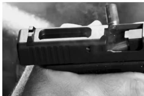
Рис. 14. Наличие дополнительной фрезеровки на рамке затвора пистолета Глок-18С
