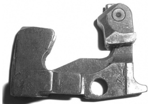
Рис. 20. Замедлитель УСМ (курка) автомата АКМ
