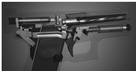
Рис. 9. Схема работы автоматики пистолета Глок-18С с коротким ходом ствола (положение ствола после вылета пули и начала движения затвора)
