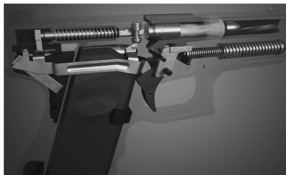
Рис. 8. Схема работы автоматики пистолета Глок-18С с коротким ходом ствола (положение ствола до вылета пули)
