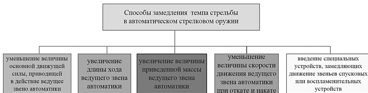
Рис. 17. Способы замедления темпа стрельбы в автоматическом стрелковом оружии
