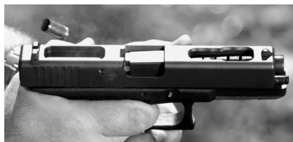
Рис. 10. Ствол пистолета Глок-18С с компенсатором
