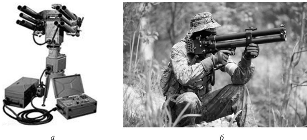
Рис. 7. Гранатометные комплексы: а — 55-мм гранатометная установка ДП-65 «Ожерелье»; б — 45-мм двухствольный гранатомёт ДП-64
