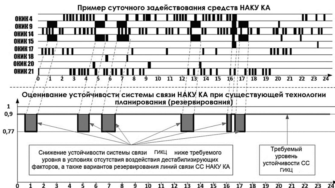
Рис. 3. Распределение трафика в системе спутниковой связи
