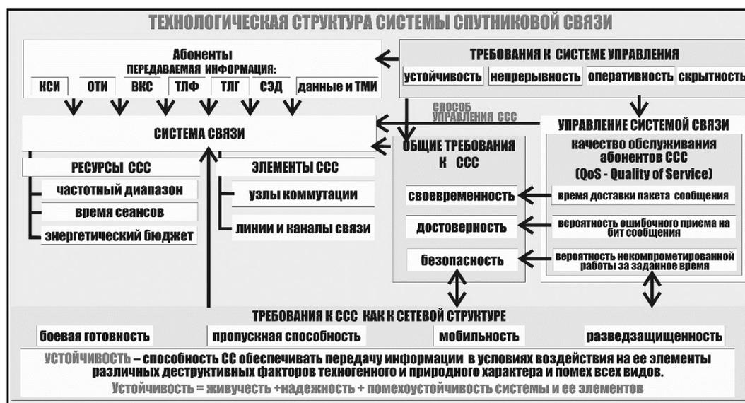
Рис. 1. Технологическая структура системы спутниковой связи
