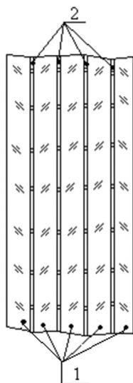
Рис. 1. Схема типовой многослойной прозрачной брони: 1 — слои стекла; 2 — прозрачный клей
