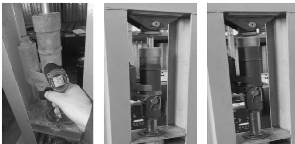
Рис. 6. Определение диапазона работы ГА на стенде
