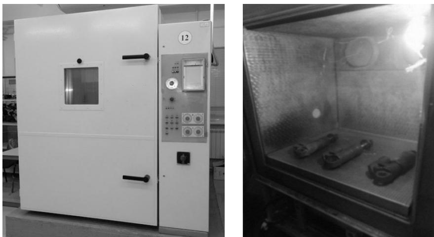
Рис. 5. Климатотермокамера КТК-800 с помещенными в нее ГА
