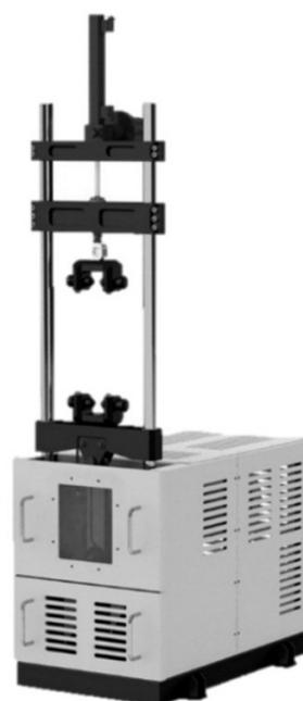
Рис. 3. Стенд ТМС 15-003 для проверки ГА
