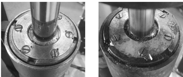
Рис. 7. Выдавливание АЖ из-под сальниковых уплотнений корпуса ГА
