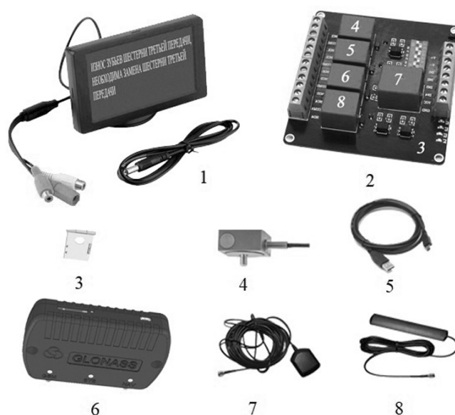
Рис. 2. Вариант комплекта комплекса дистанционной автоматизированной диагностики технического состояния коробки переключения передач ВАТ
