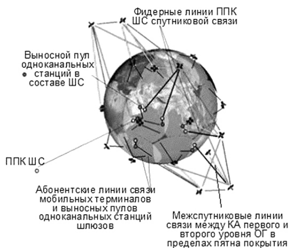
Рис. 3. Временные межспутниковые радиолинии КА 1-го и 2-го уровней и фидерные радиолинии между КА 2-го уровня и приемо-передающим комплексом шлюзовых станций
