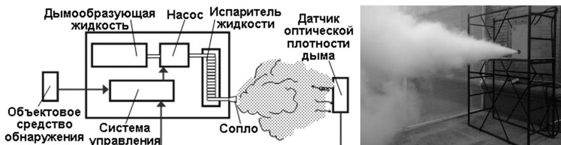
Рис. 1. Устройство и способ применения дым-машины [2]
