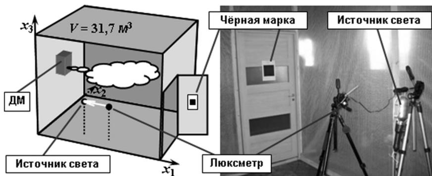
Рис. 4. Схема физического моделирования дымовой завесы, [2]
