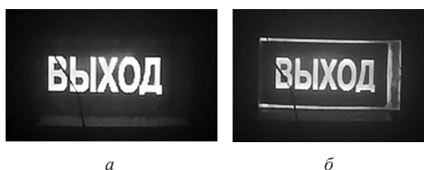
Рис. 3. Вид воспринимаемых образцов в условиях задымленности на 10-й минуте эксперимента: а — СО-3, б — СО-4
