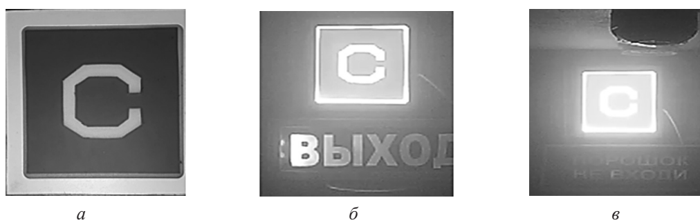
Рис. 1. Объект калибровочного свечения: а — общий вид; б — в условиях задымленности в сравнении с образцом СО-1, в — в условиях задымленности в сравнении с образцом СО-2
