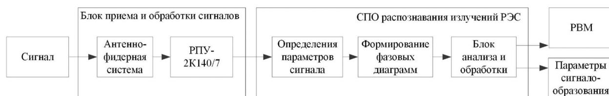
Рис. 8. Схема проведения эксперимента по приему и обработке СМНФ
