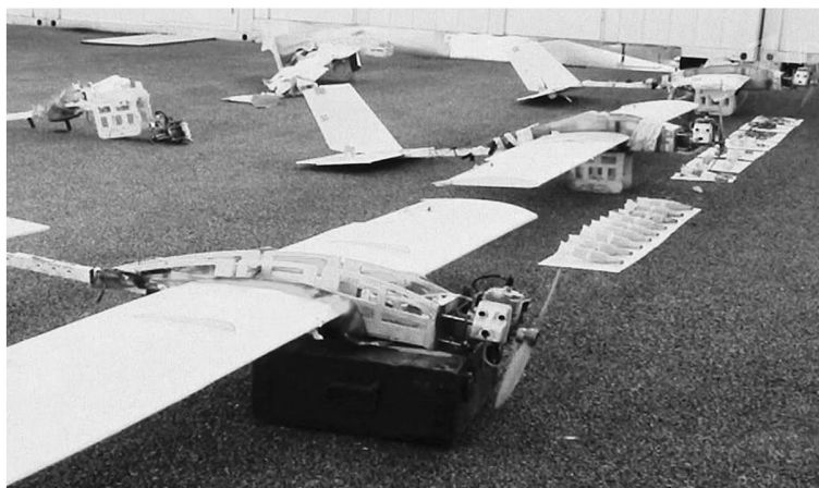
Рис. 1. Образцы террористических БЛА на основе авиамоделей «сделай сам»
