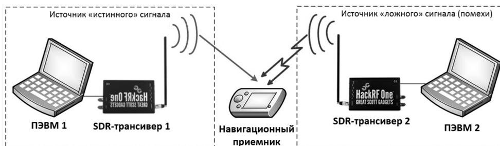
Рис. 1. Структурная схема макета формирования навигационного поля
