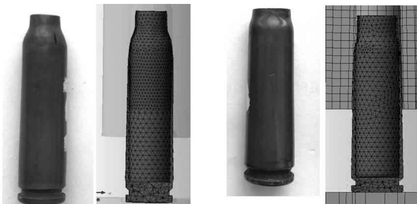
Рис. 6. Теоретическая и экспериментальная деформация гильз для систем с отдачей свободного затвора в оружии под патроны 5,45×39 и 7,62×39
