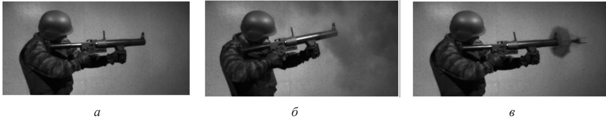
Рис. 3. Восприятие стрелком отдачи при стрельбе из гранатомета: а — t = 0 с, x_1 = 0 м; б — t = 0,008 с, x_1 = x_{1\max} = 0,02 м; в — t = 0,1 с, x_2 = x_{2\max} = 0,26 м;
