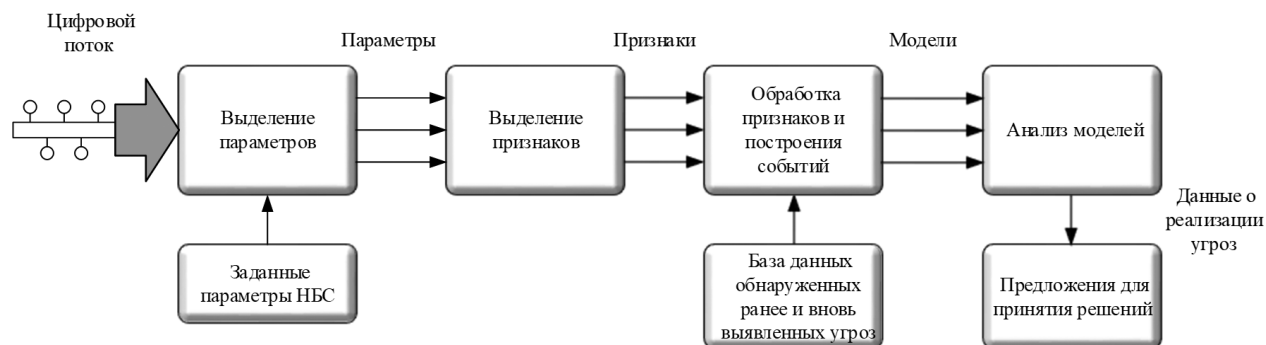
Рис. 2. Структура процесса анализа служебного трафика при сетевом контроле
